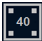
Figura 7 La «più restrittiva velocità sorvegliata all'interno della MA» nel regime d'esercizio LS, qui 40 km/h
