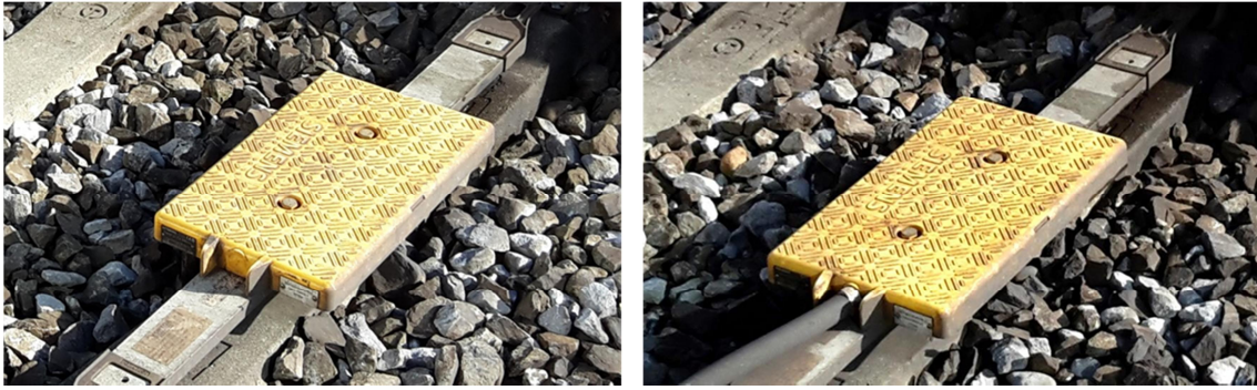
Figura 2 Balise dei dati fissi e balise dei dati trasparenti (da sinistra a destra)
