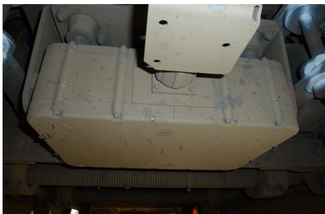
Figura 3 Antenna della balise ETCS
