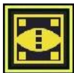
Figura 13 Simboli per l'avviso di un passaggio di Level o di regime d'esercizio
